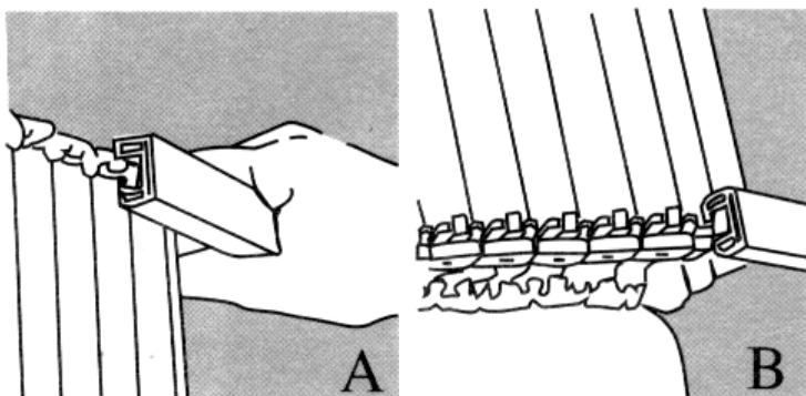
**6) Nasuňte transparentní profily (shrnovací část) do vodících profilů (horní a dolní), detail A/B**
