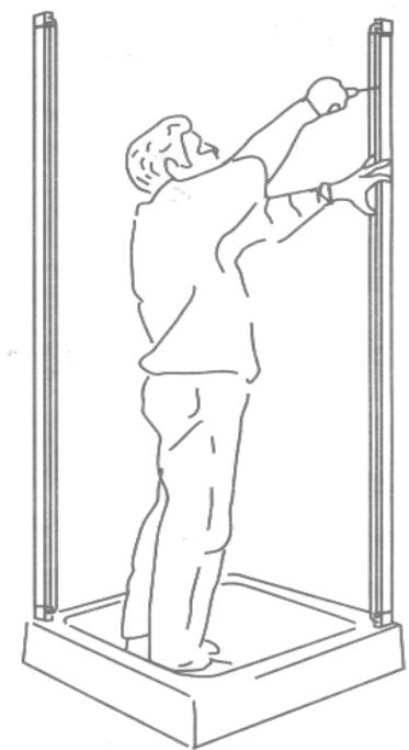
**5) Naklepněte hmoždinky do vyvrtaných děr. Naneste silikon na stěnu, kde bude rám koutu umístěn. Přiložte boční rámový profil a dotáhněte šrouby**
