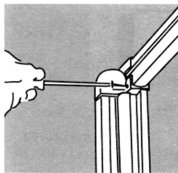
**9) Do druhého bočního profilu vtlačte krycí profil, detail F**
