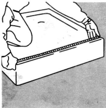
**2) Zkratěte 2 vodící profily (horní a dolní) na požadovanou délku**
