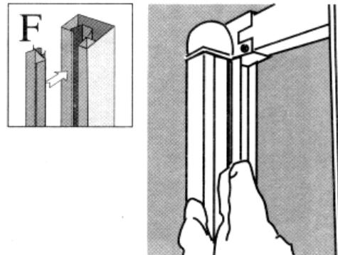
**10) Lehce nadzvedněte spodní rámový profil a naneste silikon po obvodu vaničky nebo vany, kde bude vodící profil dosedat. Na závěr zkонтrolujte velmi snadné otevírání a zavírání, které si můžete upravit před instalací na Vámi požadovanou stranu doleva či doprava.**
